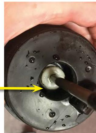
**11** Bien observer l'assemblage et démonter pour faire apparaître la cathode
